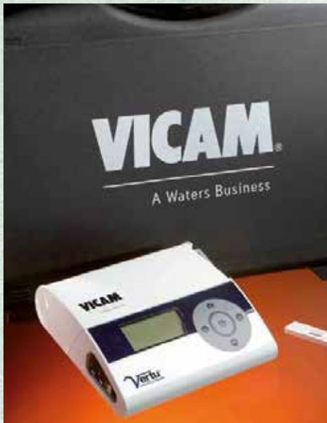
Letto Vicam per la determinazione delle aflatoxine del mais.
